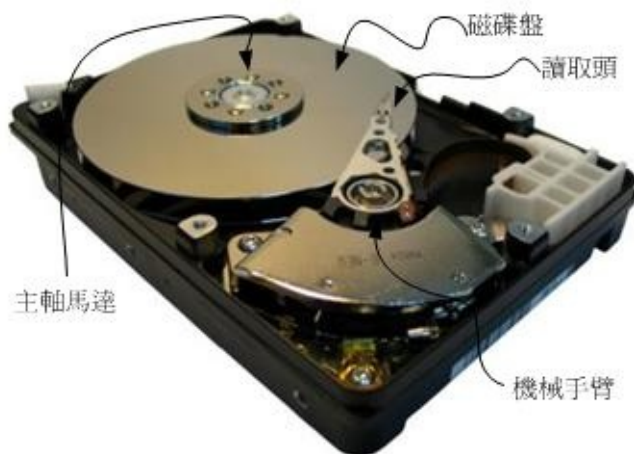
图0.2.4、硬盘物理构造（图片取自维基百科）
